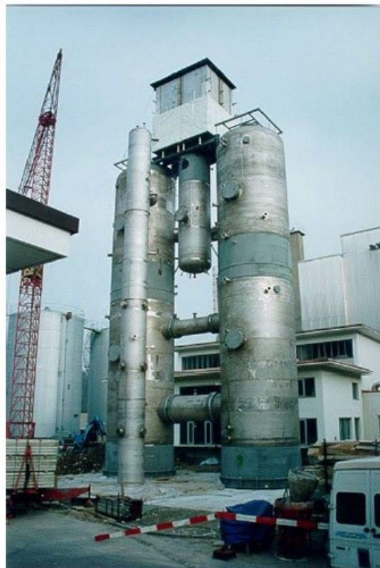
Экспериментальная установка PANDA (PSI, Швейцария) Объем 2-х сосудов 183,3 м 3
